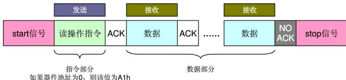
只要在读取数据以后单片机向24C512发送应答信号就可以继续读取下面的数据，24C512中的地址计数器会自动加1。
