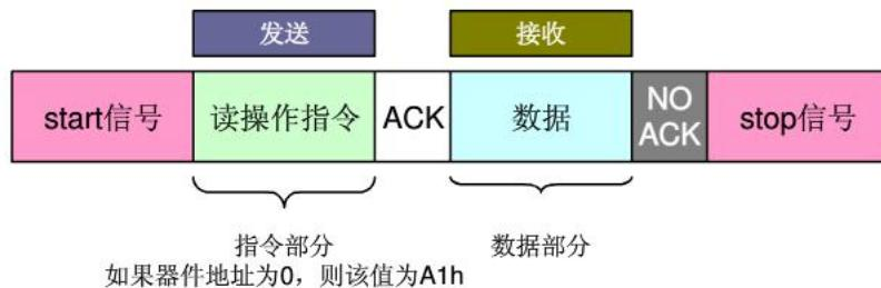
24C512中有一个地址计数器，读写操作会改变指针的值，【读当前地址的数据】指令的地址就是最后一次读写操作的地址值作为数据接收方的单片机在读取完数据后直接发送STOP信号，不回复ACK信号。
