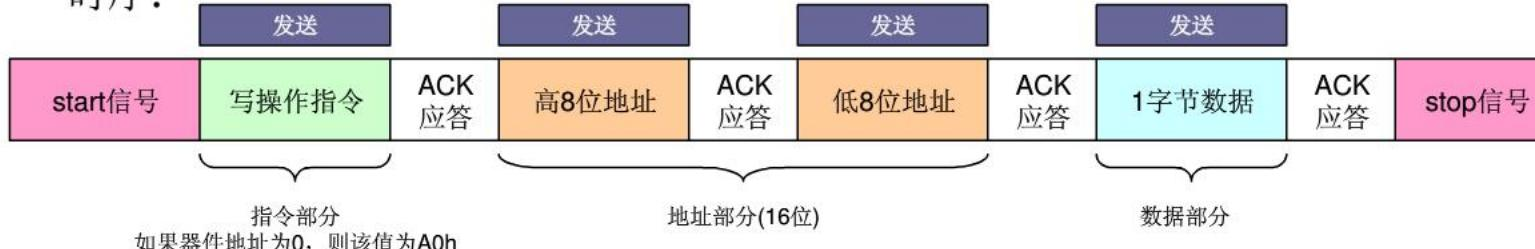
操作开始，单片机需要发送start信号来占用I2C总线，随后发送写操作指令A0h，判断应答信号为有效后再分2次发送写入地址，每次发送完都要判断24C512返回的应答信号。数据跟在地址后面发送给器件，同样，也要判断ACK应答。最后发送stop信号来释放I2C总线。
