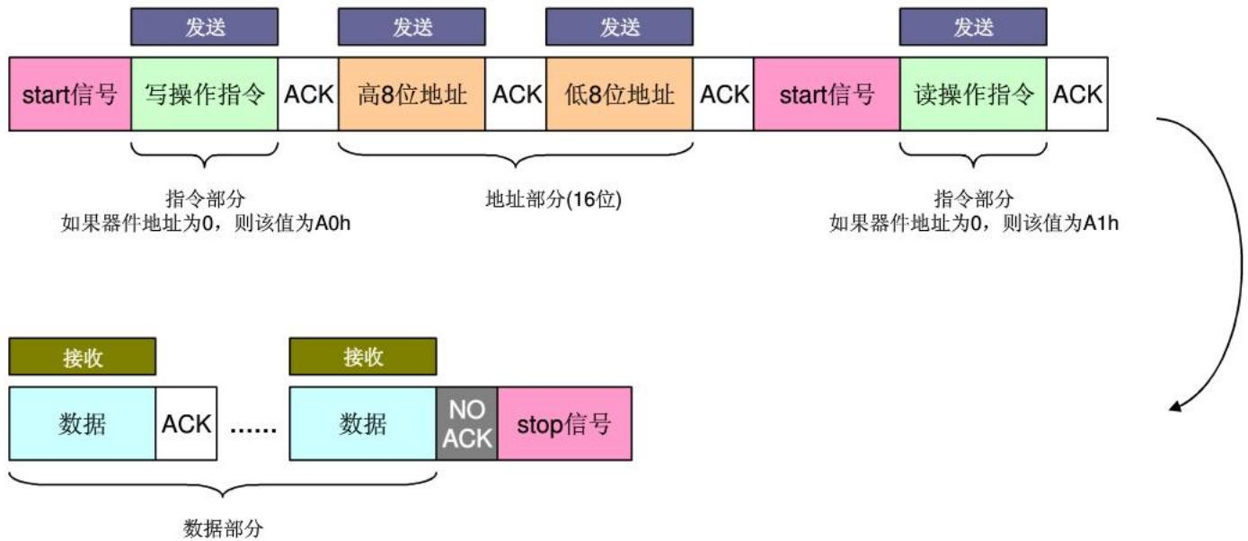
和上一个类似，单片机只要在读取数据后向24C512发送了ACK应答，就可以读下一个数据。读取结束后，单片机要发送NoAck信号和STOP信号，释放总线。
