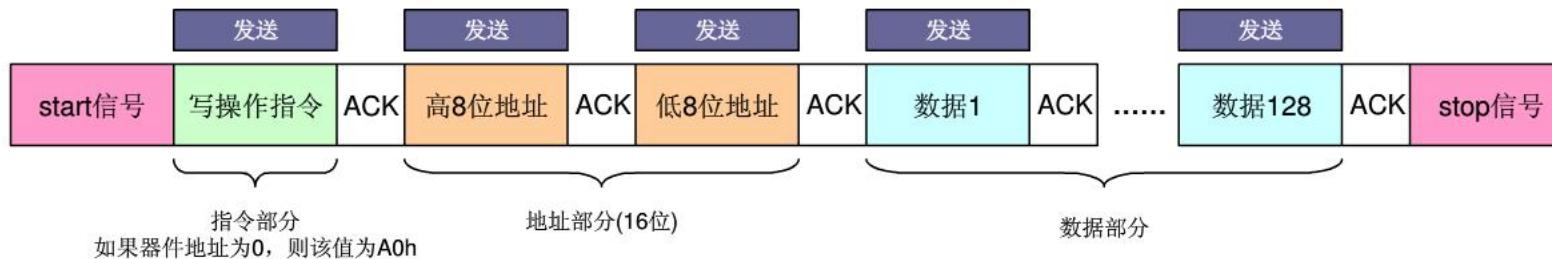
24C512可以进行每次长达128个字节的页写入操作。页写入时，直到写入完第一个字节前，所有的操作过程都与字节写入完全一样，不同的是单片机不会在写入第一个字节后发送STOP信号，而是继续写入，最多可以再写入127个字节（算上第1次写入的总共不超过128个字节）。在写入全部数据后，单片机必须通过发送STOP信号来停止页写入操作。
