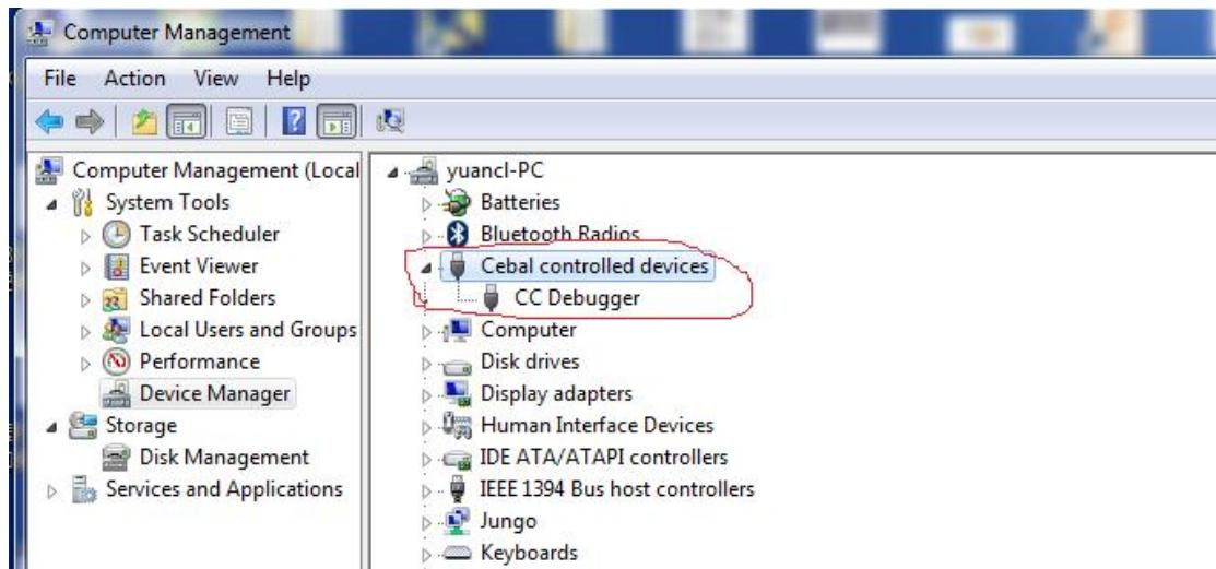
6. 从上述可以判断 CC debugger 下载器有问题造成无法正确加载驱动程序
