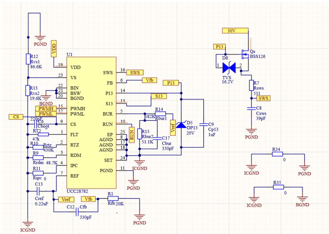
图 1.1 测试启动过程电路
