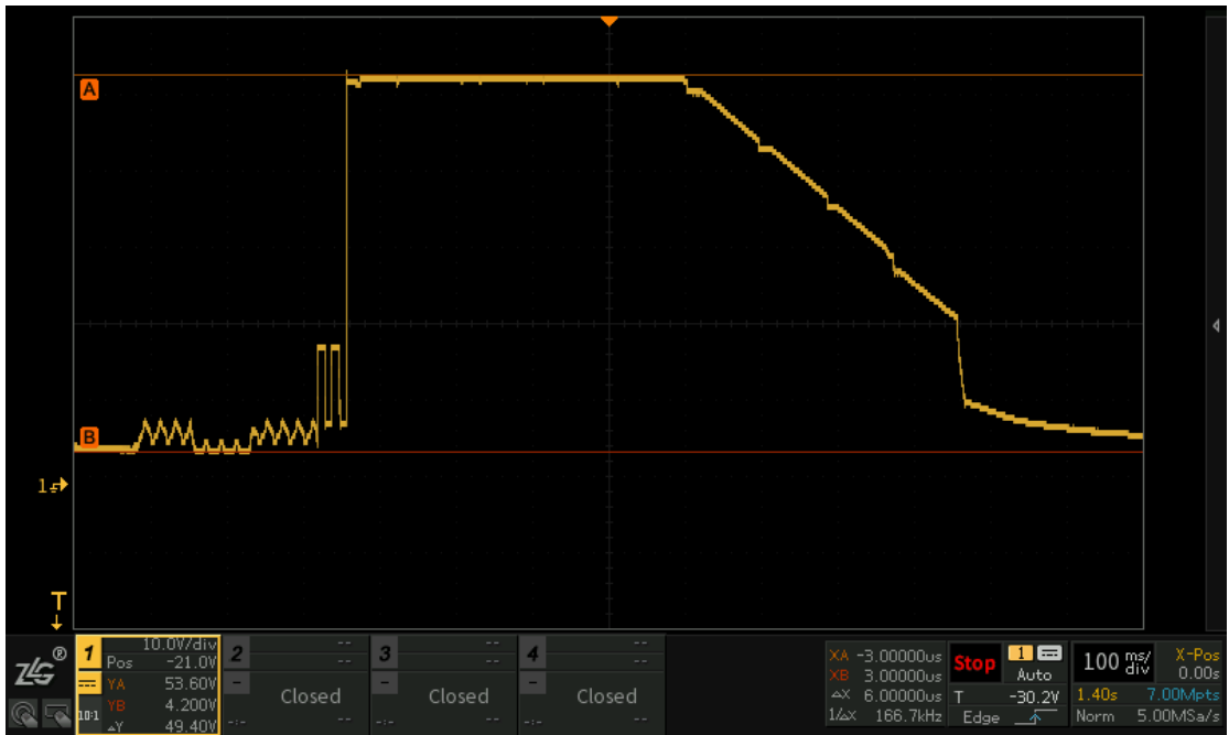
2.VDD 握手波形 (POE 输入整流后的 50V)
