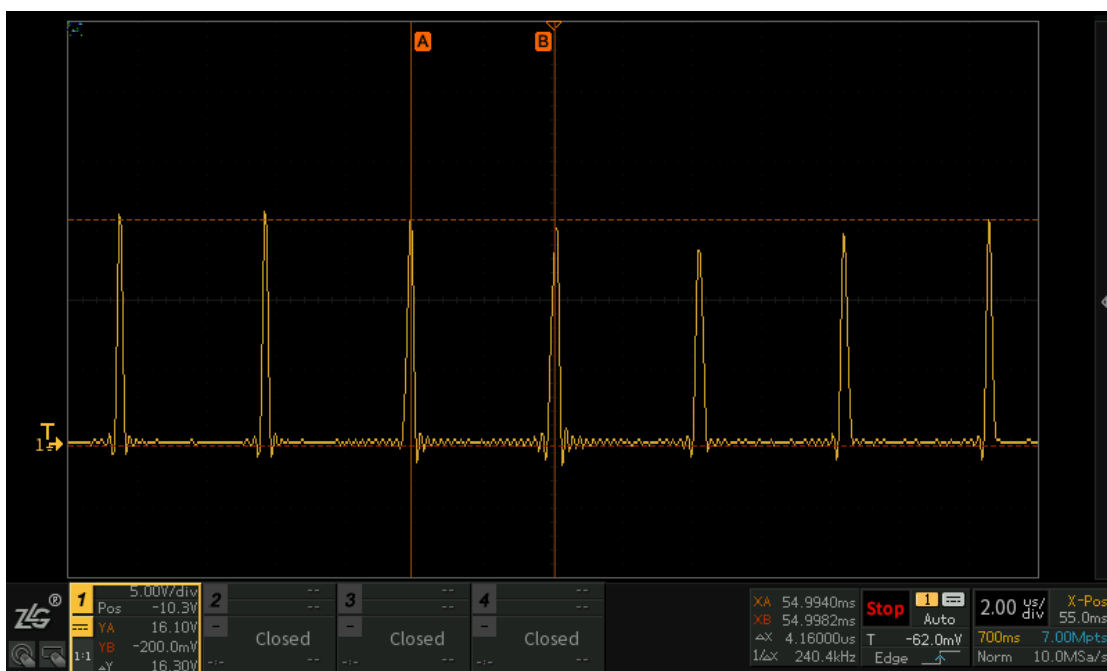
6. GATE 局部放大波形 (240K 16V 尖脉冲)
