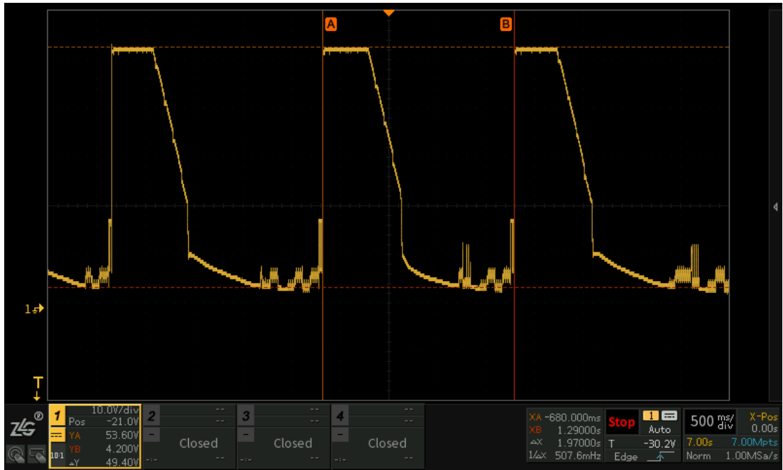
1.VDD 波形 (POE 输入整流后的 50V)
