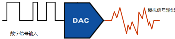
图 4-1 DAC 将数字信号转换为模拟信号
