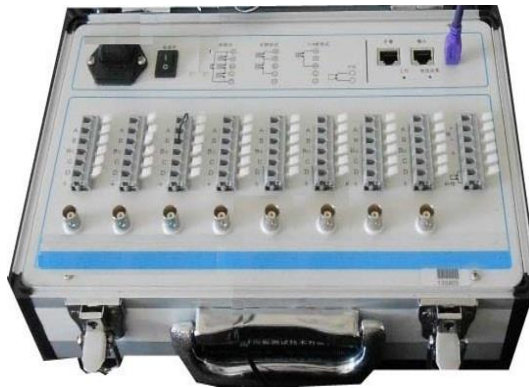
图 1-4 北京一洋研制的静动态应变仪
