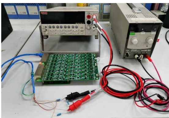
图 5-3 桥路激励补偿传输线电阻测试连接
