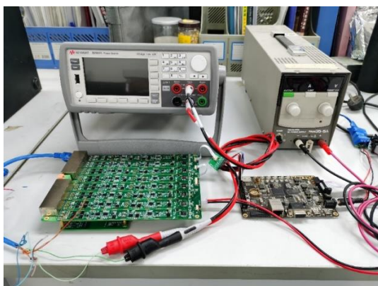
图 5-4 电压测量精度测定连接
