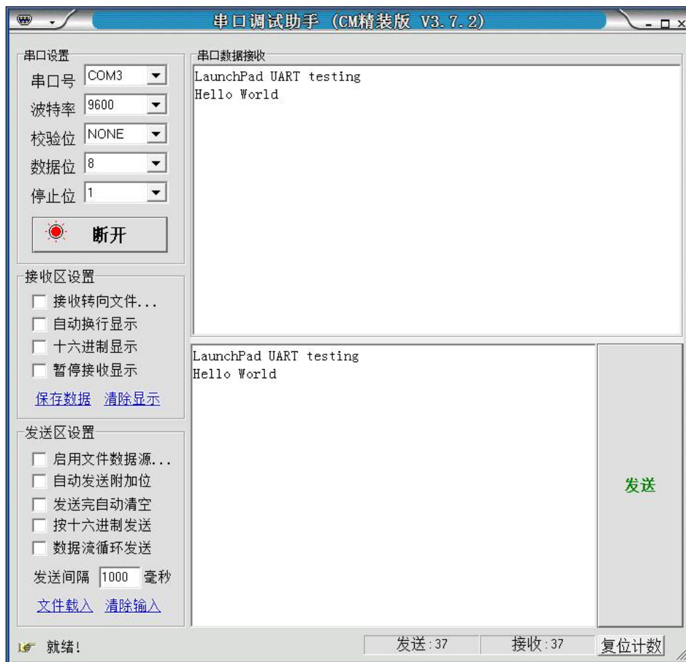
图5.5.3 PC机发送字符后由单片机接收并回发
