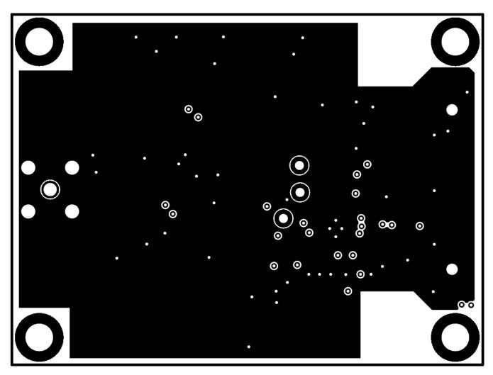
Figure 15. ADS7049-Q1EVM PCB Layer 2: GND Plane
