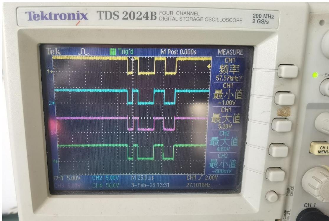
注意：唯一可单方向收发数据的情况，必须断掉发端的 D 线。如果是 1#给 2#发数据，2#的 R 端电压最低不是 0V，此时 2#板子 TTL 光纤模块输入引脚与 2#板子上 R 引脚是相接的，真实 2#板子 TTL 光纤模块输入引脚是 0 与 5V 的跳变而不是大于 0V
