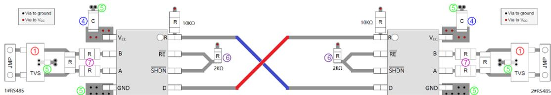
2.2.1 初始上电，此时 1#板子 TTL 光纤模块输出引脚与 1#板子上 D 引脚是闭合状态，无数据发送
