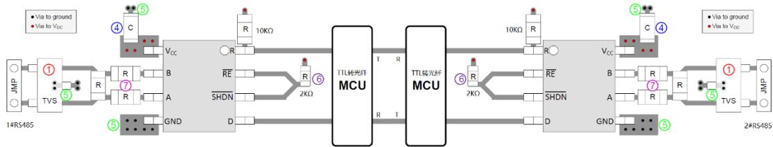
2.1.1 初始上电，此时 1#板子 TTL 光纤模块输出引脚与 1#板子上 D 引脚是闭合状态，无数据发送
