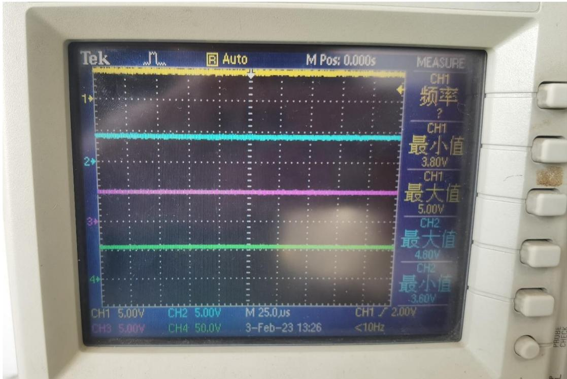
注意：此时 4CH 的电压是光纤 TTL 输出的，电压比默认板子的 R 电压要高 0.1-0.2V
