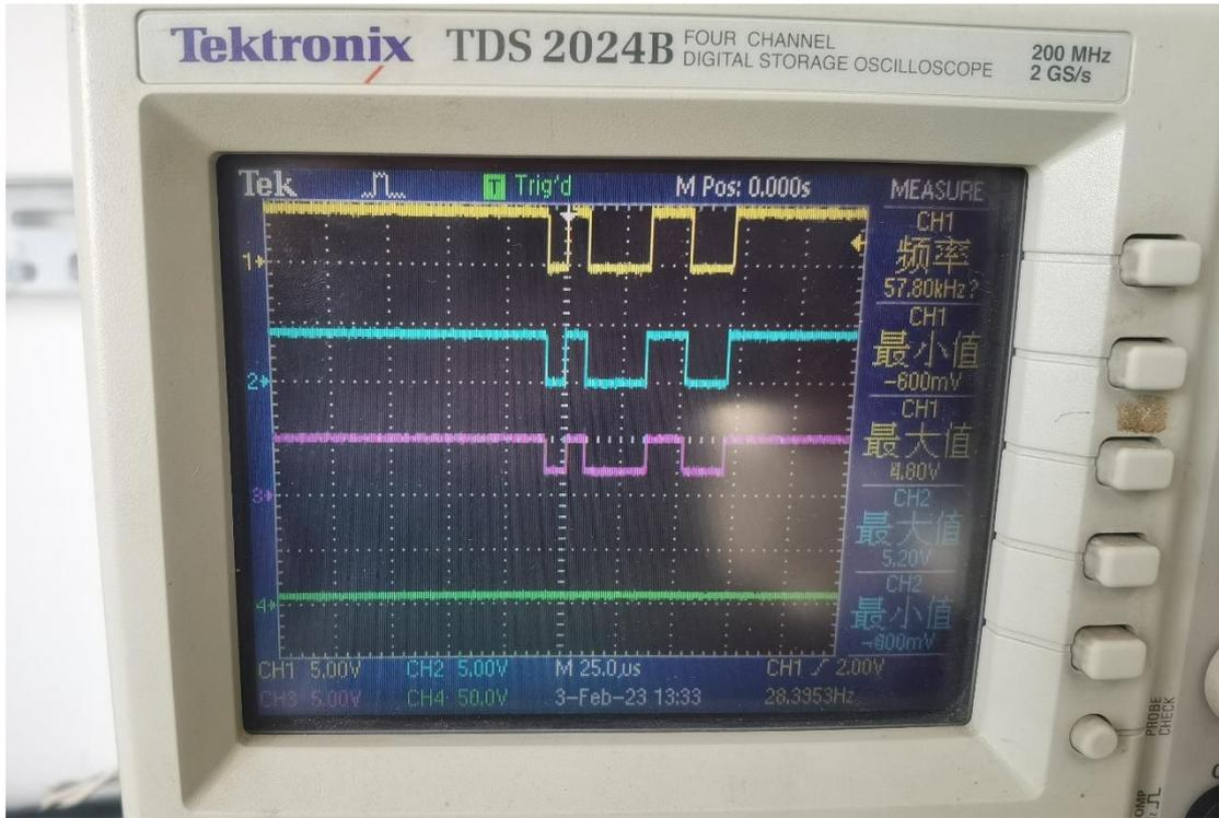
注意：唯一可单方向收发数据的情况，必须断掉发端的 D 线。如果是 1#给 2#发数据，2#的 R 端电压最低不是 0V，断开 2#板子 TTL 光纤模块输入引脚与 2#板子 R 引脚，0V 信号被进一步拉升
