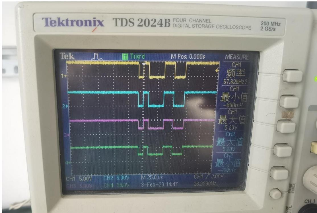
注意：正常工况下，两板子数据交互通讯正常。若 1#给 2#发送数据，则 2#R 与 1#D 均被拉升电压。反之若 2#给 1#发送数据，则 1#R 与 2#D 均被拉升电压。
