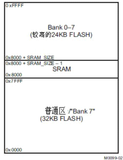
图 2-3 用于运行来自 SRAM 的代码的 CODE 存储空间
