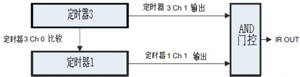
图 9-7 定时器在 IR 产生模式的方框图
