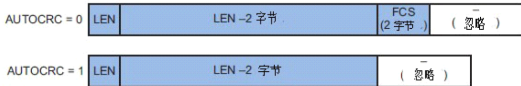
图 19-5 写入 TX FIFO 的帧数据
