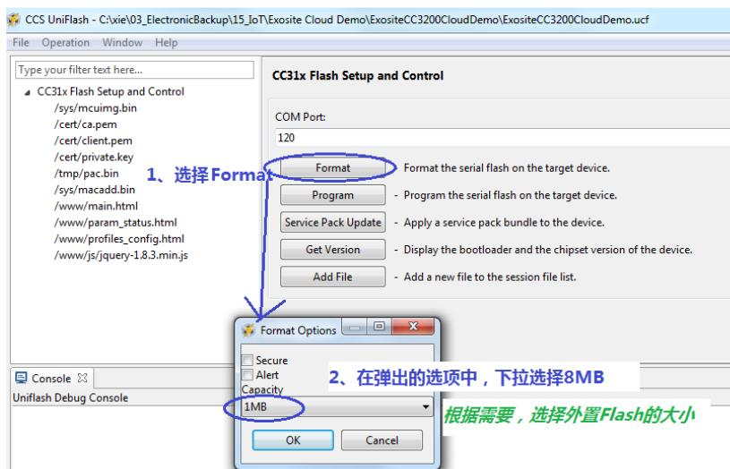
点击 OK 确定，在 Console 界面出现“please restart the device”的提示后，按下板子的复位键，等待擦除完成。
