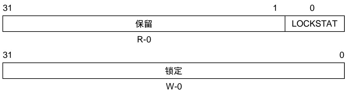
图3-4 PCFGLOCK寄存器图[地址: 0x01B3F018]-读/写通道
