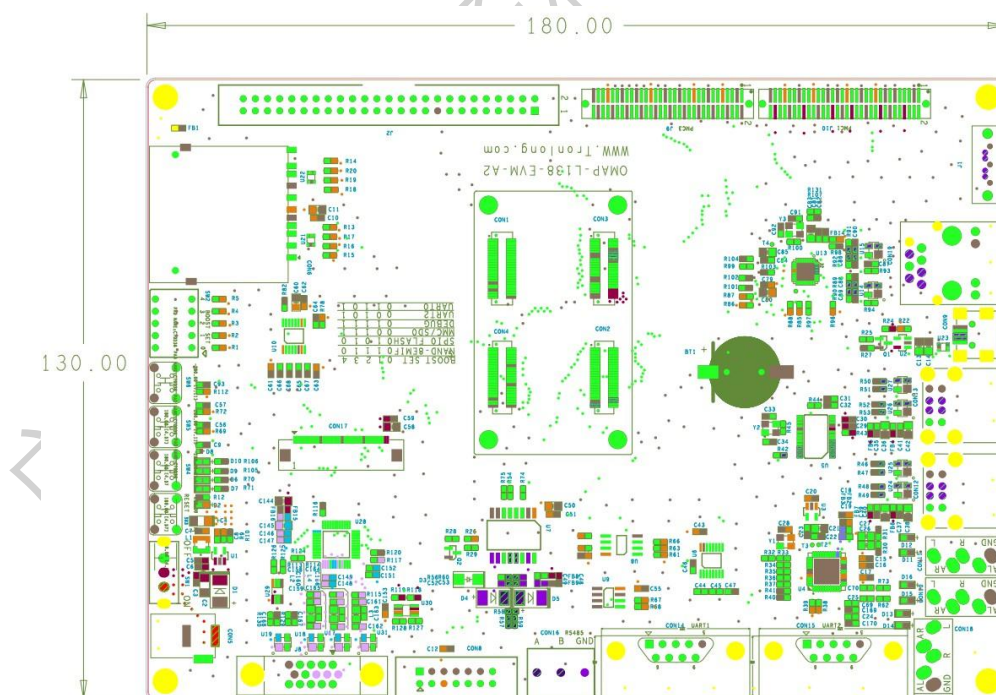
图 12 AM1808 开发板机械尺寸图
