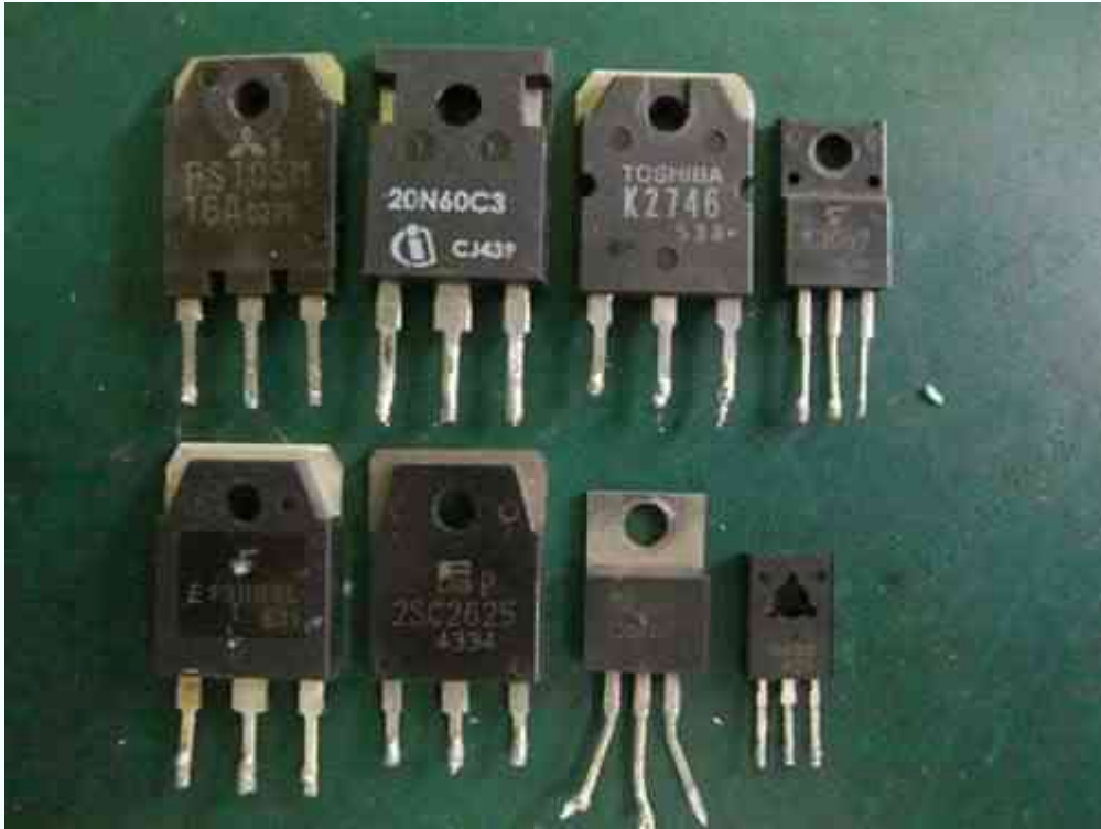
照片中上方为电源内常见的 N MOSFET(N 型金氧半导体场效半导体管), 下方则是 NPN BJT(NPN 型三极管)
