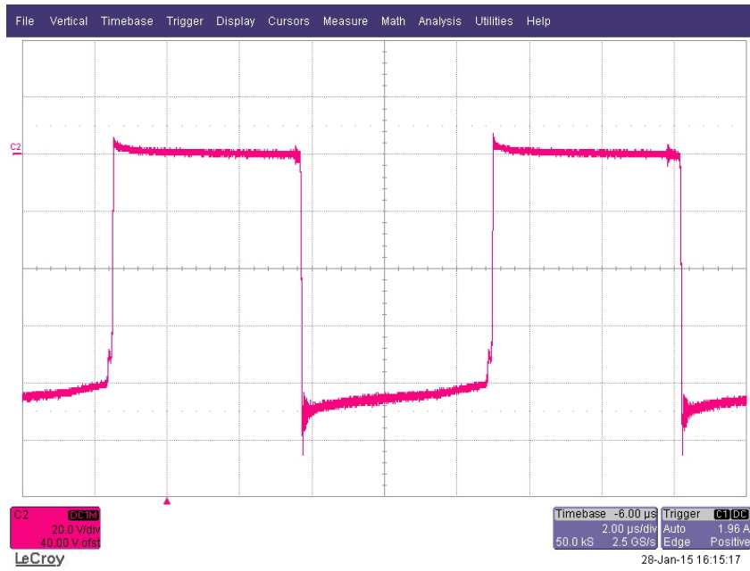
图 16. 满载, CV/CC 转换点
