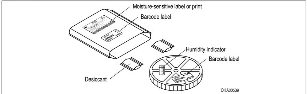
Anm.: Feuchteempfindliche Produkte sind verpackt in einem Trockenbeutel zusammen mit einem Trockenmittel und einer Feuchteindikatorkarte
