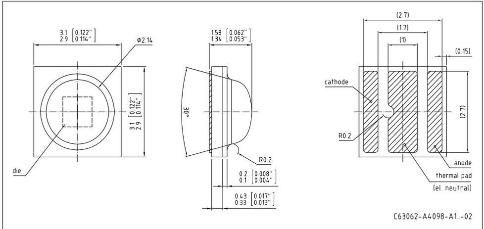
Anm.: Die LED enthält ein ESD-Bauteil, das parallel zum Chip geschaltet ist.
