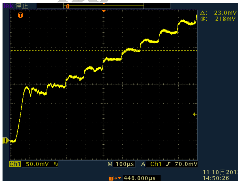
图 3: 输出电压的步进幅度
