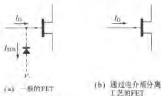
图 4.2 FET 的构成与电介质分离技术
