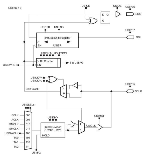
Figure 14-1. USI Block Diagram: SPI Mode
