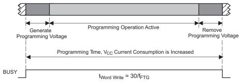
Figure 7-7. Byte/Word Write Timing
