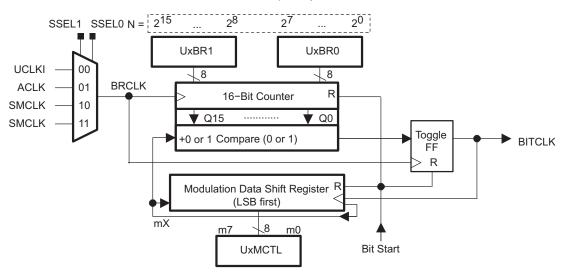
Figure 18-7. MSP430 Baud Rate Generator
