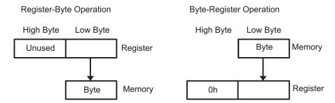
Figure 3-7. Register-Byte/Byte-Register Operations
