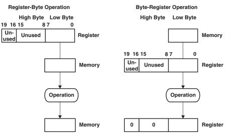
Figure 4-10. Register-Byte/Byte-Register Operation
