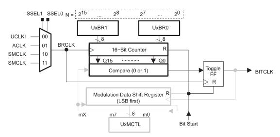
Figure 19-8. SPI Baud Rate Generator
