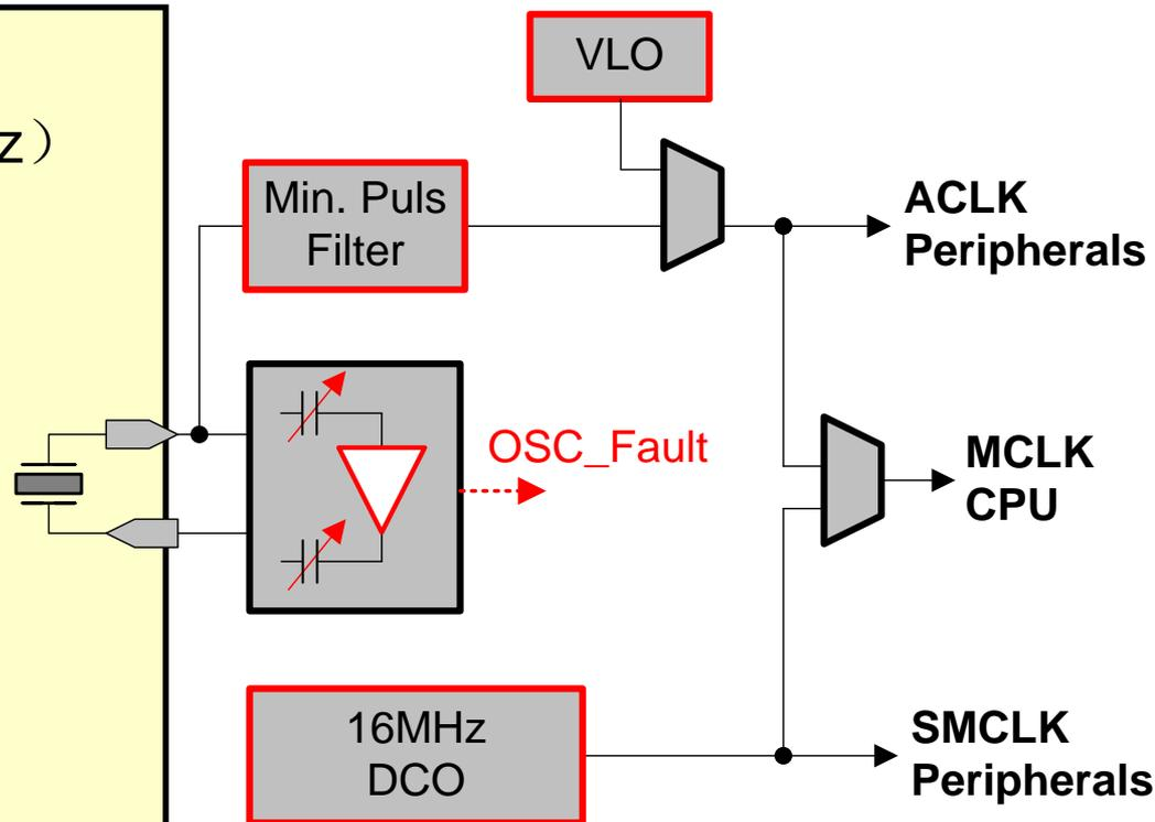
MCU PUC后, MCLK 和 SMCLK 由 DCOCLK 提供 (约 1.1 MHz)。在 LF 模式中, ACLK 由 LFXT1CLK 采用一个 6pF 内部负载电容提供。
