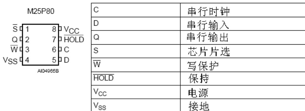
图 6-2 M25P80 的芯片图与引脚功能定义
