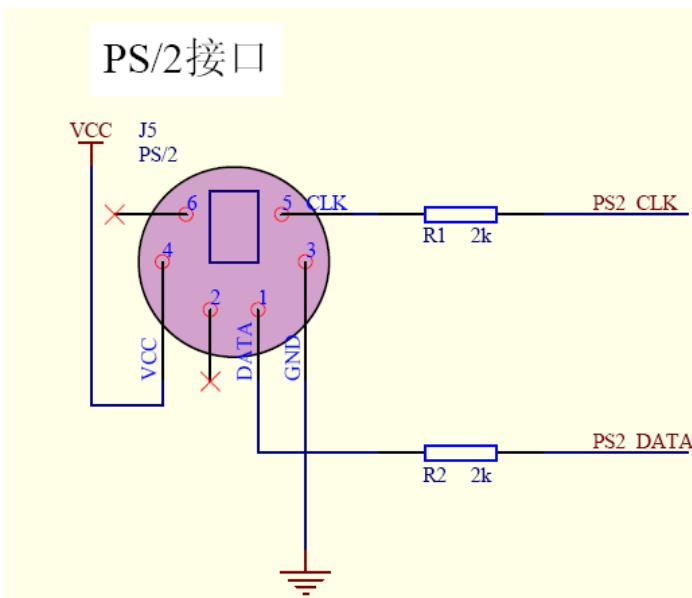
ps2\_led：实验结果为 ps2 键盘键值按下，将键值显示在 LED 灯上
