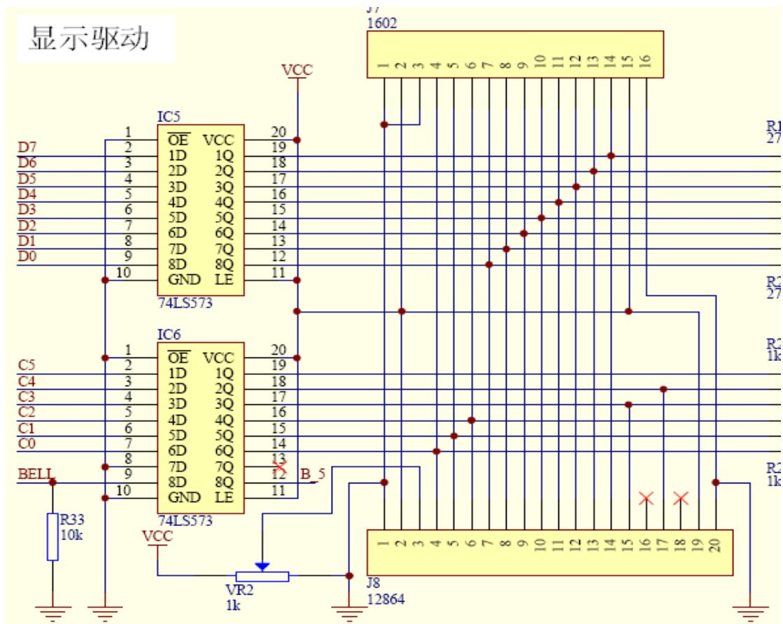
在做 1602 或者 12864 液晶实验时，如果液晶显示亮度很低是由于 usb 供电不足所造成，可以选择将数码管控制 J10 跳帽拔下，以减少电流损耗！
