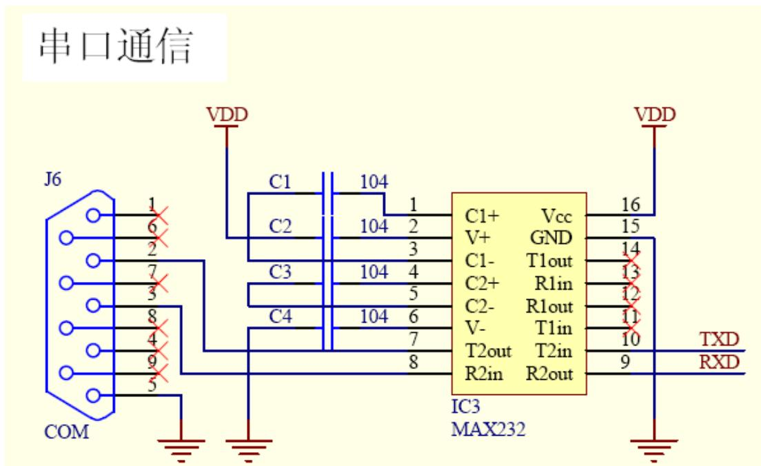
uart0：实验结果为 MCU 不停向 PC 机发送数据,在屏幕上显示 0~127 对应的 ASCII 字符
