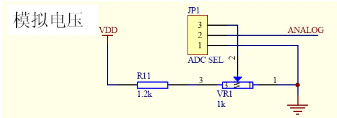
在做 AD 实验时，请将跳帽插到 AD\_SEL 上端
