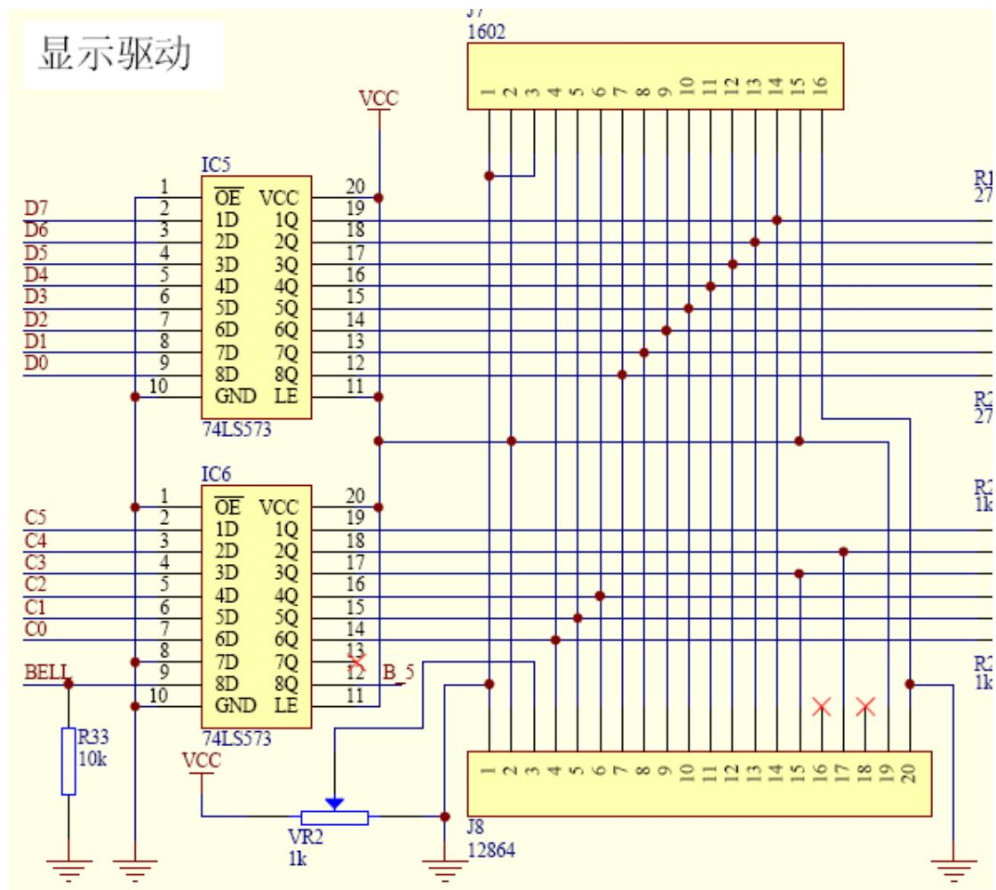
在做 1602 或者 12864 液晶实验时，如果液晶显示亮度很低是由于 usb 供电不足所造成，可以选择将数码管控制 J13 跳帽拔下，以减少电流损耗！
