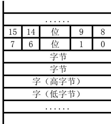
图 4.3: 字节结构存储器中的位、字节和字
