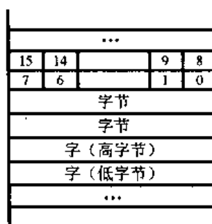
图 4.3 字节结构存储器中的位、字节和字
