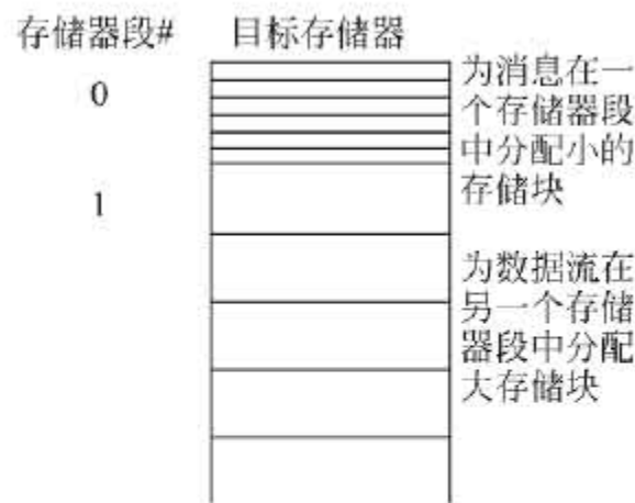
图 5-1 使用不同存储器段分配不同尺寸的存储块
