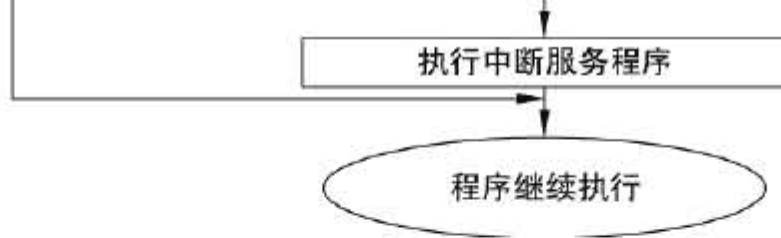
图 4-3 调试停止状态下的中断处理顺序
