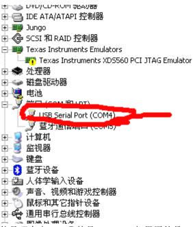
可以看到具体是哪个串口,我的是 COM4。如果用的是 USB 转串口线,可修改对应的串口端口。具体方法:右击对应的串口端口,本例中是 USB Serial Port(COM4),-->属性-->端口设置-->高级,这时可以看到下图界面
