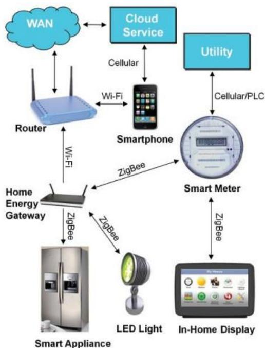
图 2: 部分 TI 智能电网通信功能
