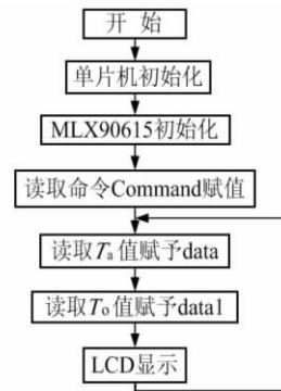
图8 测温程序总流程
