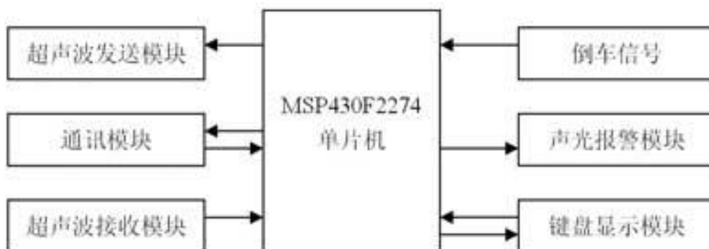
图 1: 倒车雷达系统框图。
