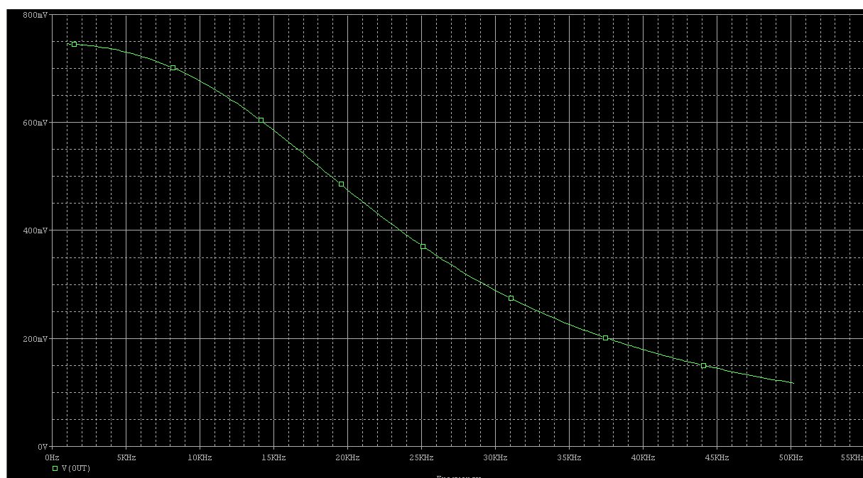
图 6 低通滤波器的 SPICE 交流特性仿真结果
