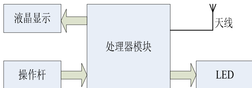
图 3.1.1: 协调器的硬件框图
