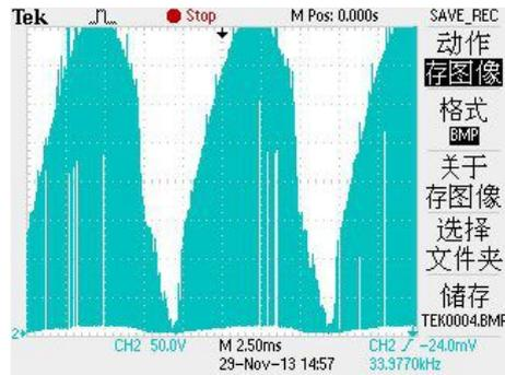
接调光器最大输出时调光器的输出波形：
