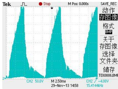
接调光器50%输出时调光器的输出波形:
