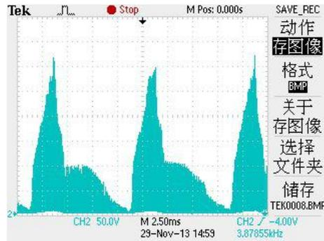
接调光器最小输出时调光器的输出波形:
