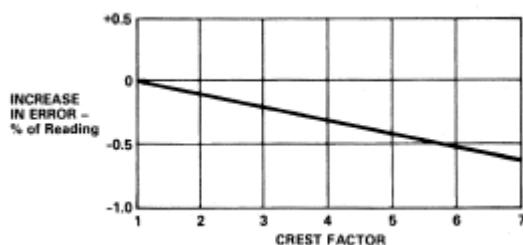
图31. AD636的误差与波峰因素关系曲线
