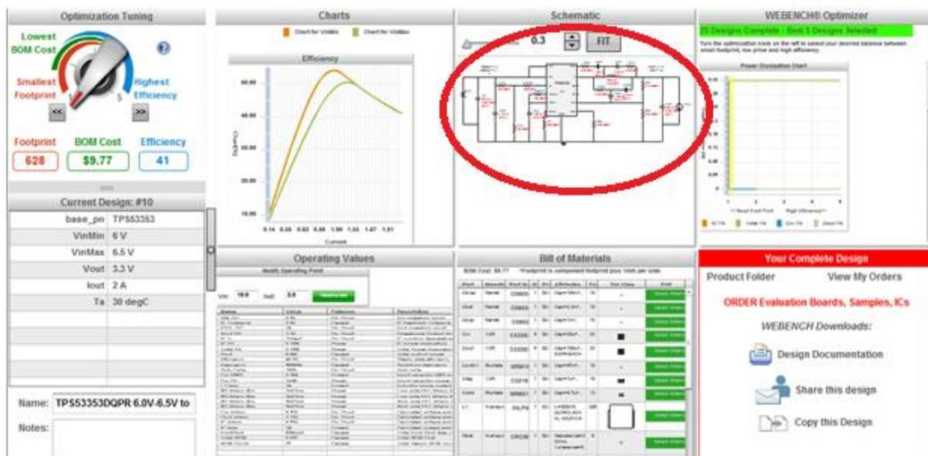
设计面板的原理图中可以进行仿真，点击原理图后即可进入电源电路，可以看到右上角有 Run Simulation，可以对电路进行仿真。
