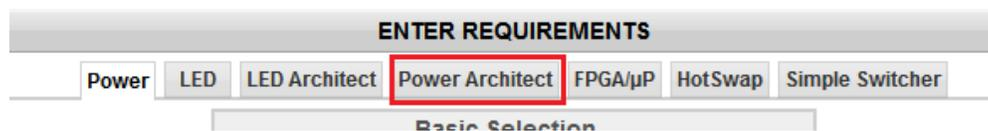
在 WEBENCH 的开始界面点击“power architect”进入电源架构设计。WEBENCH 的电源架构设计正是本着“电源树”的设计思想进行设计的，把工程师从繁重的电流加减，电压分配、芯片选型中解脱出来，把精力放在系统电源总体设计上。
