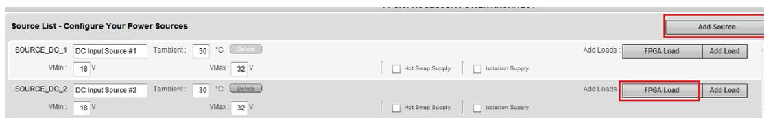
在 source 2 上点击“FPGA load”即可对新添加的“树根”选择 FPGA 电源。需要注意的是要把 source 1 中的 vccint 删除，避免出现重复。
