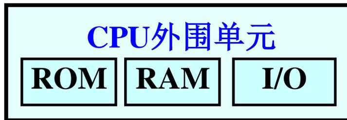
与CPU运行直接相关的单元电路，与CPU构成单片机的最小系统。
